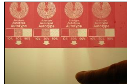
Uno stencil sotto-esposto è morbido sul lato della racla
