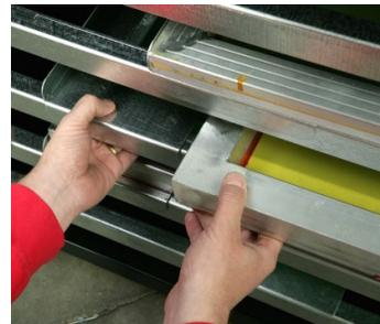
PLUS-Emulsionssiebe sollten stets horizontal - mit der Rakelseite nach oben - getrocknet werden, damit die Emulsion auf der Druckseite des Siebes trocknet. Wird das Sieb vertikal getrocknet, besteht die Möglichkeit, dass die Emulsion verläuft, bevor sie zu trocknen begonnen hat, wodurch es zu einer sichtbaren „Schleierbildung“ der Emulsion kommt, oder aber zu einer höheren Matrizendicke (EOM) im unteren Rahmenbereich.
